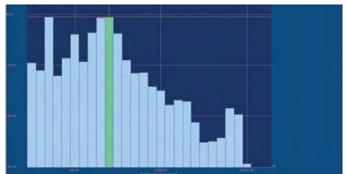
Die Signatur "Constant Percentage Bandwidth" (CPB) vermittelt einen generellen Überblick über einen Großteil der mechanischen Fehlermerkmale wie Unwucht, Versatz und Lockerheit des Fundaments. Ihr besonderes Kennzeichen ist aber die spezifische Empfindlichkeit für die Identifizierung von Fehlern wie Walzkörperlager-Fehler, Hohlraumbildung, Resonanz in der Brennkammer und Gasaustritte.
